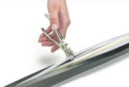
Abbildung 6: Durchtrennen eines Mikroröhrchens Quelle: Rehau
